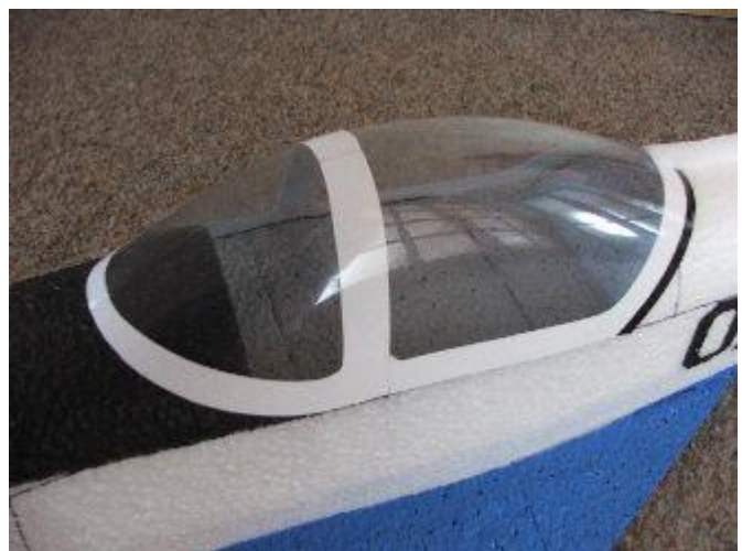
Ostříhnout kabinu a nalepit orámování
