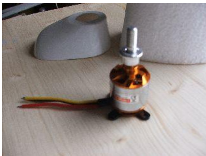
Sestavíme motor s upevňovacím křížem.
