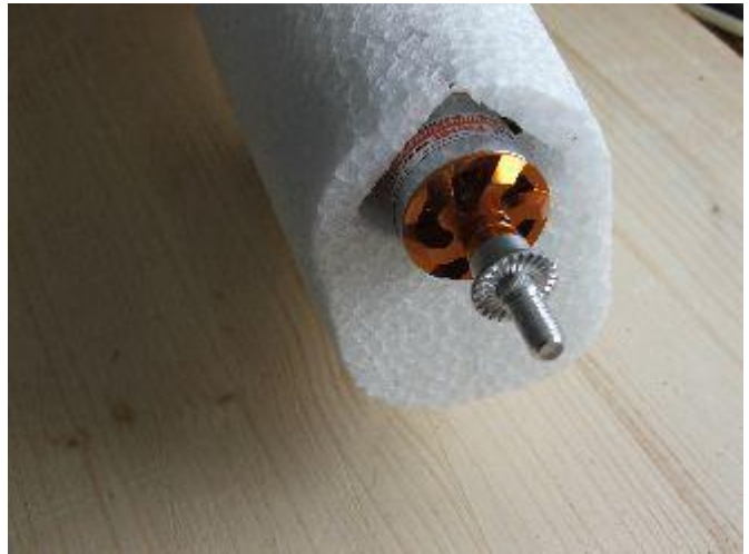
Motor přišroubujeme na překližkovou přepážku.
