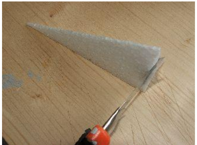
Šikmo seříznout a zabrousit zadní díl přechodu..
