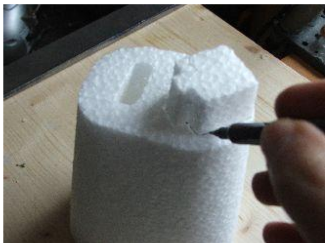
Slepíme přední EPP díl trupu. Vnitřní část vysuneme co nejvíce dopředu. V místě vysunutí uděláme rysku.
