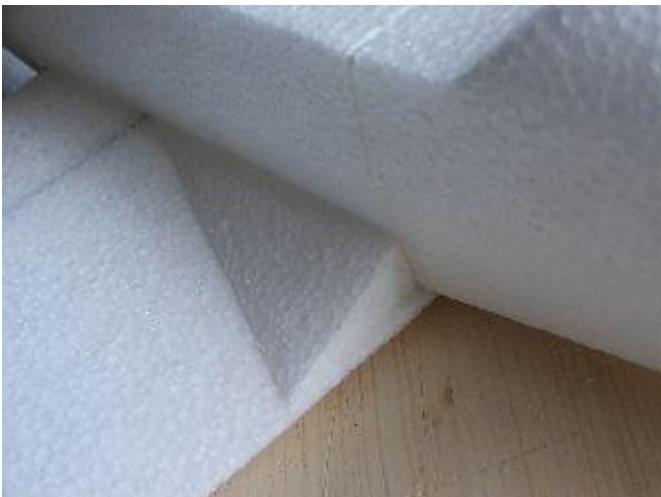
K trupu přilepit přední část přechodu křídlo trup.
